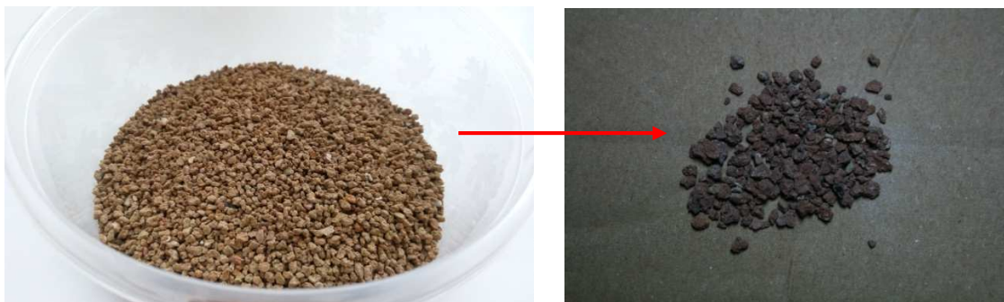
Obrázok 12 Bentonit pred (vľavo) a po (vpravo) zahrievaní pri teplotách od 110 – 400 °C
