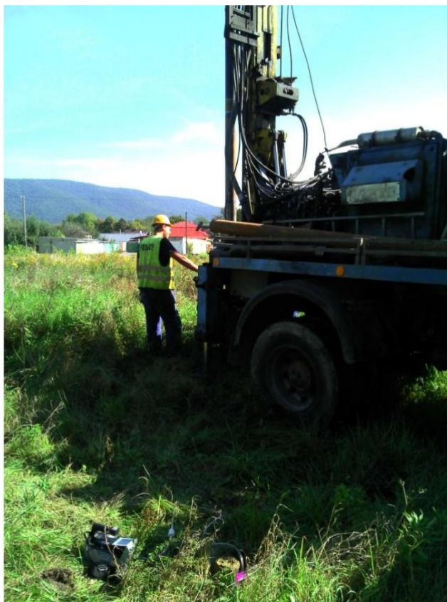
Obr. 3. Odber pôdneho vzduchu prístrojom Ecoprobe 5 do sorpčnej trubičky [2].
