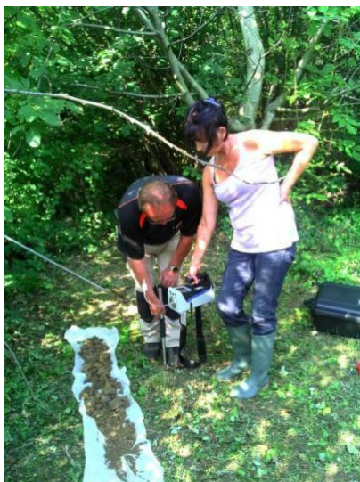
Obr. 2. Meranie pôdneho vzduchu prístrojom Ecoprobe 5 (hlbka 2m) [2].
