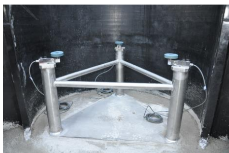
Obr. 3. Váhový systém lyzimetra a hydrologický vrt
