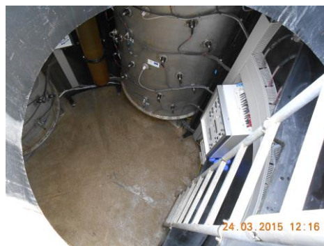
Obr. 4. Lyzimetrické valce s osadenými senzormi a pohľad do vnútra kontajneru s lyzimetrami.
