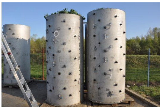
Obr. 4. Lyzimetrické valce s osadenými senzormi a pohľad do vnútra kontajneru s lyzimetrami.
