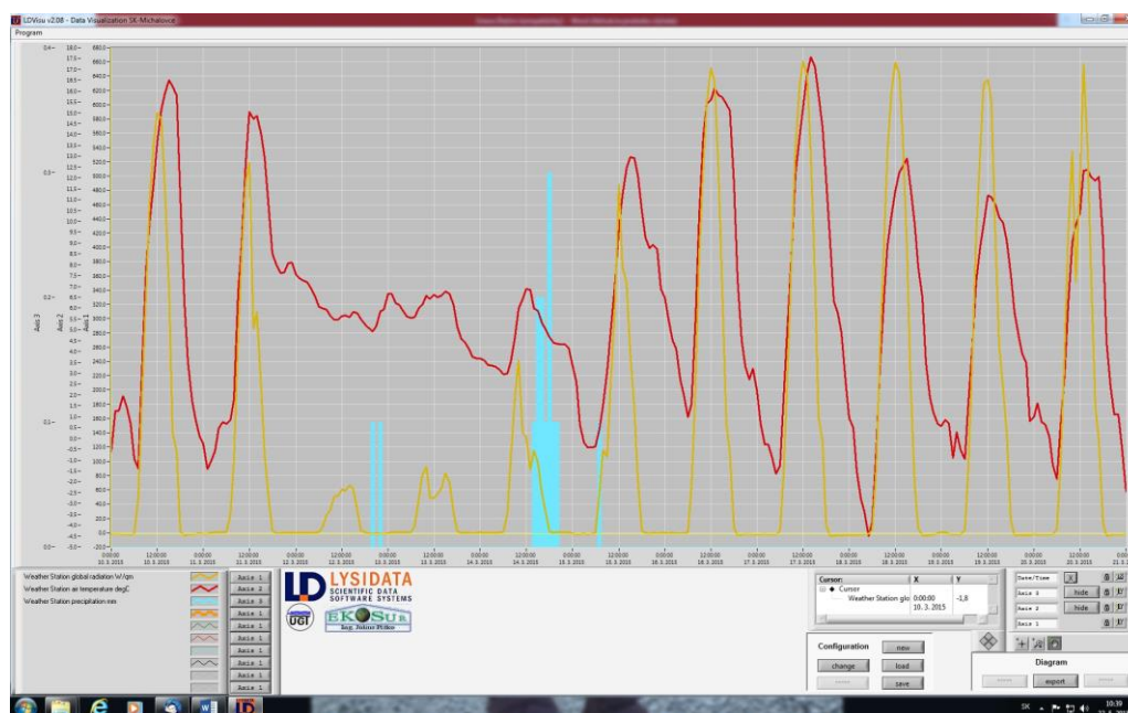
Obr. 6. Ukážka dátových výstupov (globálne žiarenie (žltá), teplota vzduchu (červená), úhrny zrážok (modrá))
