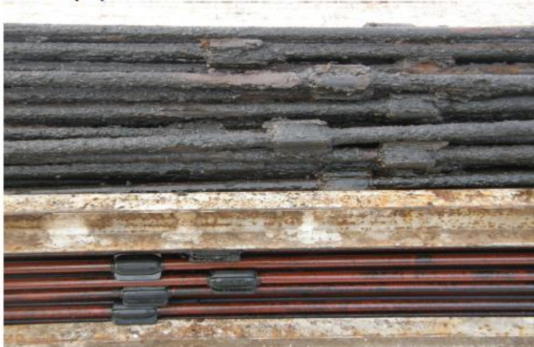
Obr. 4. Tiahlice vytiahnuté zo sondy obalené parafínom (hore) a čisté tiahlice (dole na obrázku).
