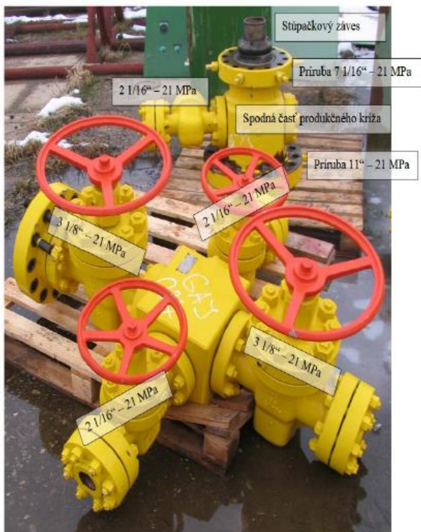
Obr.6. Produkčný križ plynovej sondy a jeho jednotlivé časti [1].
