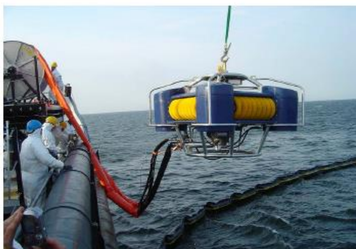
Obr. 2. Odsávačka (vákuový odsávací stroj) na odsávanie ropných škvŕn z vodnej hladiny od firmy Lamor [3].
