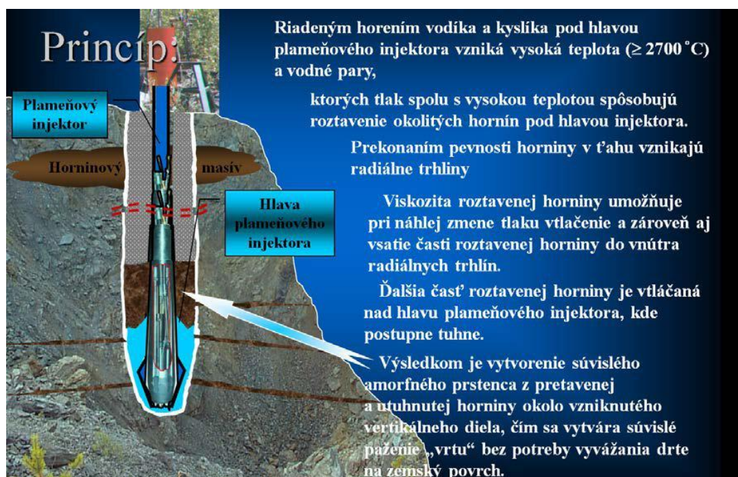
Obr. 1. Interakcia nástroja termického hĺbenia s okolitou horninou [1].
