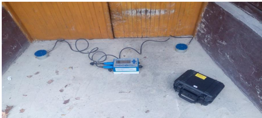
Obr. 2. Umiestnenie prístroja na základy obytnej budovy v obci Nimnica.
