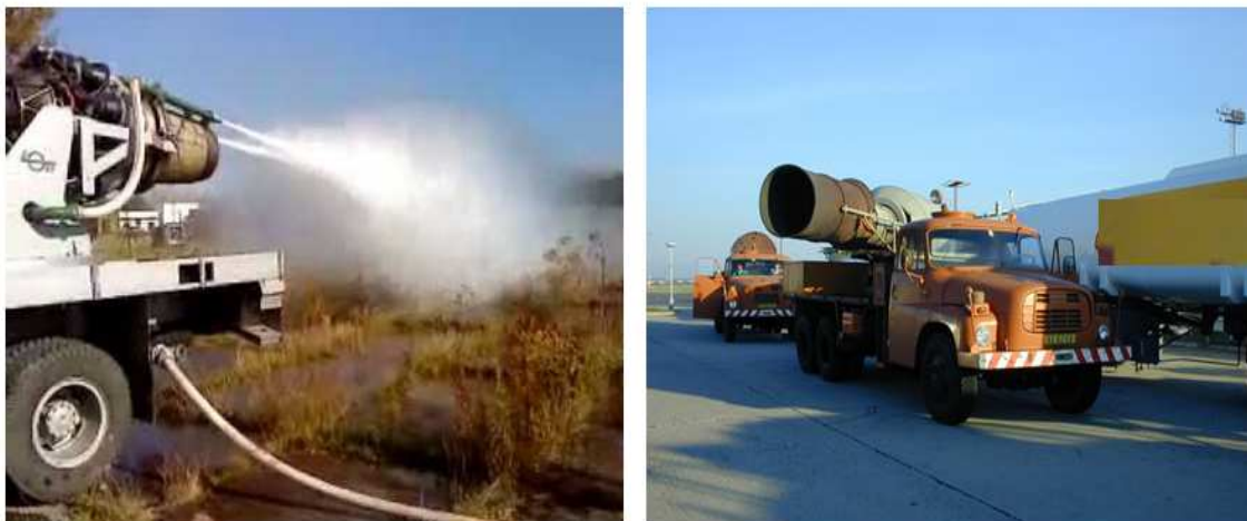
Obr. 4. Likvidácia havárií a erupcií pomocou automobilu plynovodného hasenia APVH (vľavo na obrázku) a automobil plynovodného hasenia APVH (vpravo na obrázku). [3]
