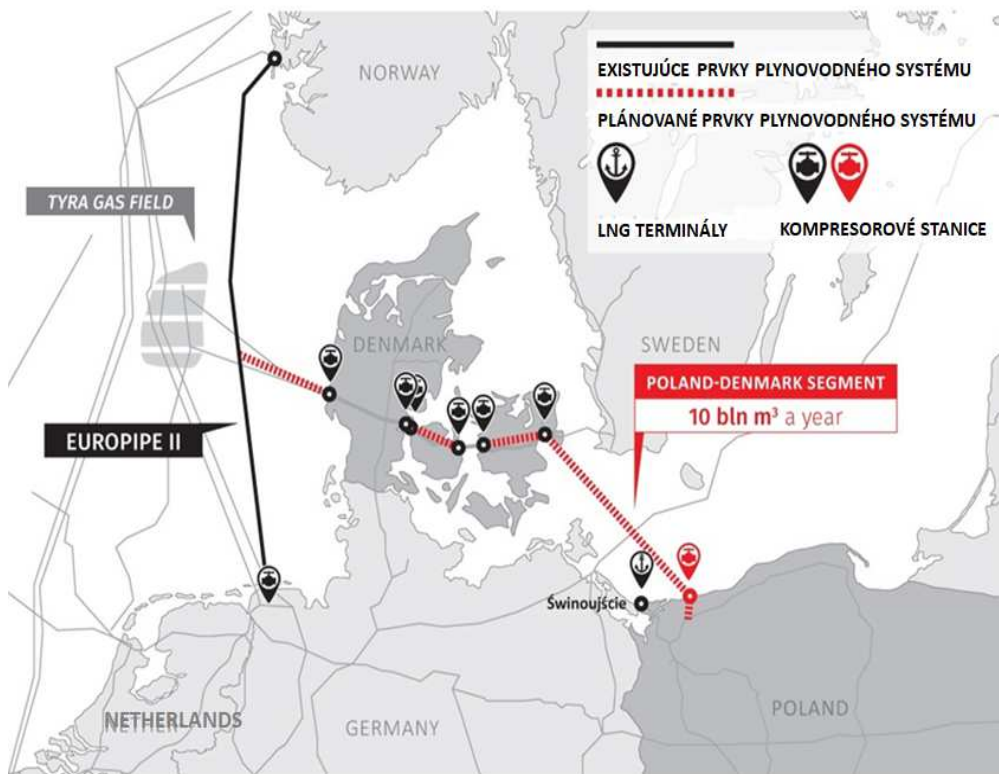
Obr. 3. Navrhovaná trasa plynovodu z LNG terminálu Świoujście (Poľsko) cez Dánsko k Nórskemu koridoru k plynovodu EUROPIPE II. (Poznámka: skratka bln m 3 a year, znamená bilióm m 3 za rok) ( podľa [1] upravil autor)
