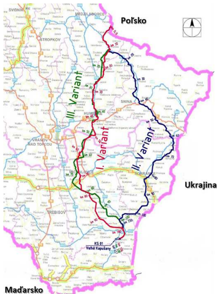
Obr. 4. Navrhované tri varianty prepojovacieho plynovodu z Veľkých Kapušian – Lupkovský priesmyk [9]
