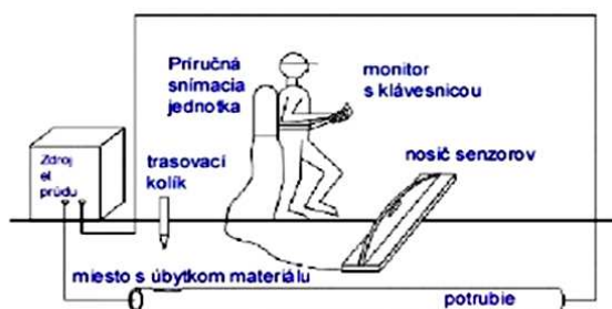
Obr. 1. Schéma inšpekcie potrubia technológiou NoPig [9].
