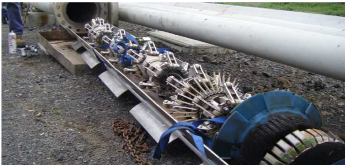
Obr. 13. Elektromechanický ježko na meranie geometrie potrubia [1].
