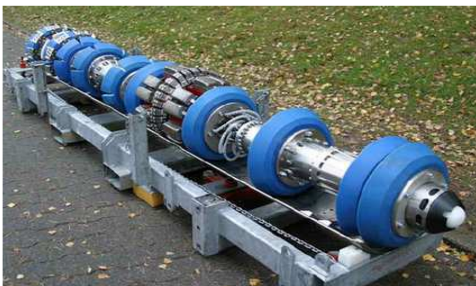
Obr. 12. Ultrazvukový obojstranný čistiaci ježko [1].
