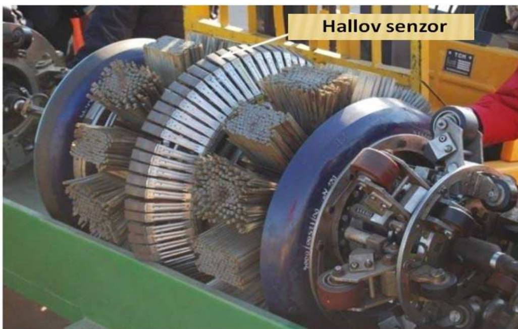
Obr. 10 Situovanie Hallovho senzora na čistiacom ježkovi pri detekcii metódou rozptylu magnetického poľa MFL [9].
